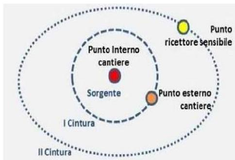
Figura 9 – Schema concettuale delle cinture di monitoraggio
