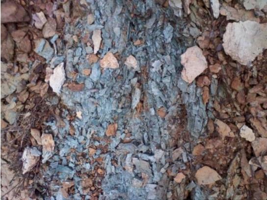
Figura 15 - Esempi di litotipi potenzialmente amiantiferi: SAC (scisti actinolitico-cloritici) – Si rinvencono lungo zone di taglio e/o nelle zone di contatto tra metabasiti e serpentiniti. Serpentino e Tremolite-Attinolute sono presenti e frequentemente possono cristallizzare con abito fibroso
